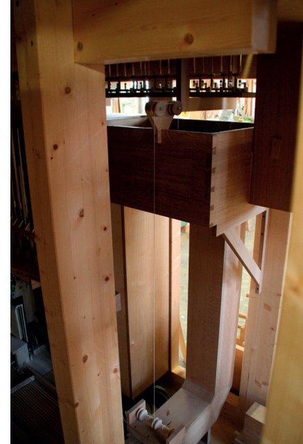
Windkanal, Balg und Rollendrossel des Hauptwerkes
