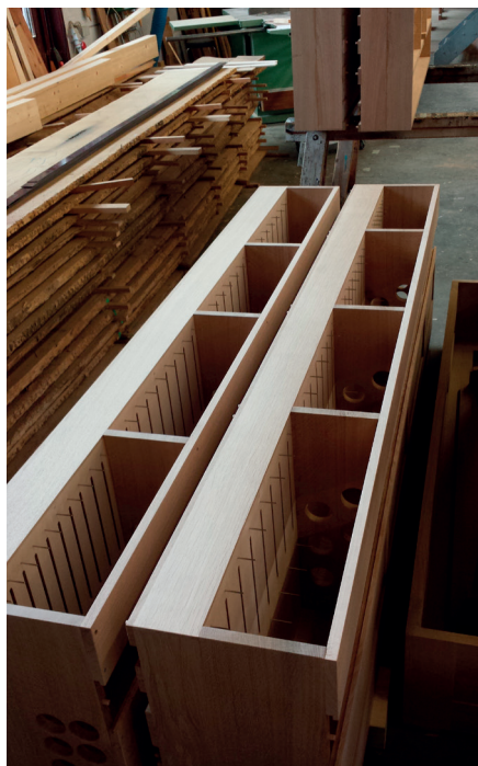
Windladen während der Herstellung
