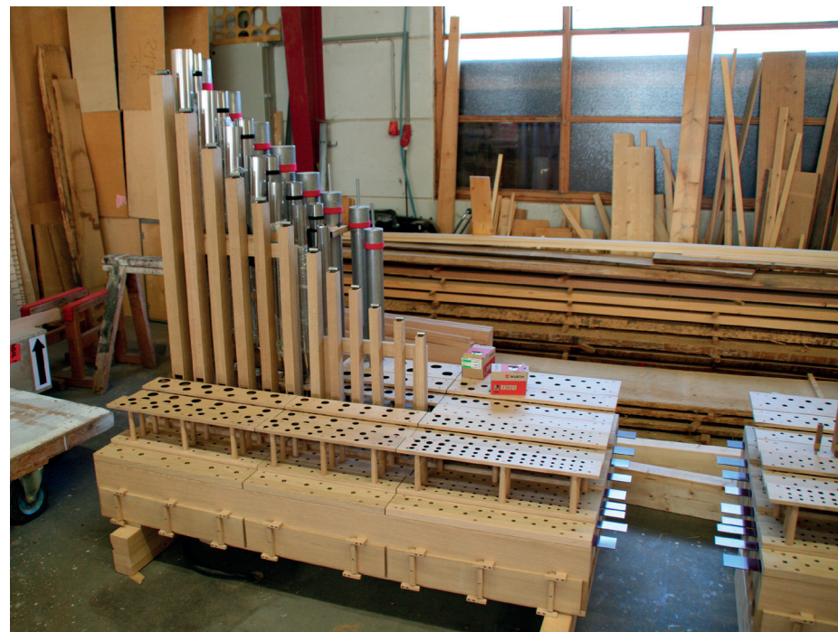
Die Windladen des Positivs in der Werkstatt
