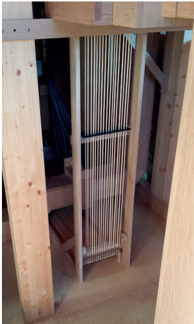
Pedalabstrakten im Unterbau der Orgel
